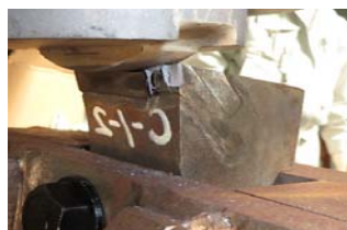
写真-5 母材の圧壊状況
