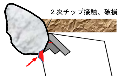
図-5 巨礫による破損イメージ
