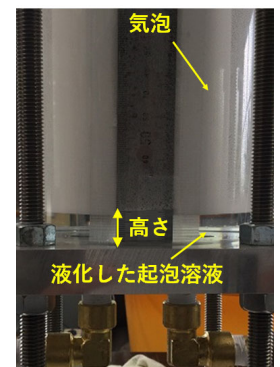
写真－2 液化状況
