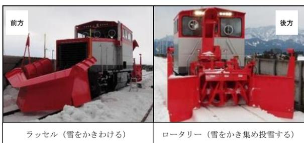
図-2 JR西日本で採用している除雪車
