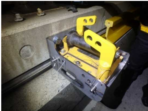
写真 2 インサート利用の D 型支承装置
