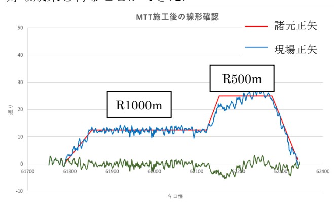
図7 施工後の現場正矢
