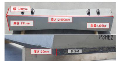
図-2 弾性PCマクラギ寸法
