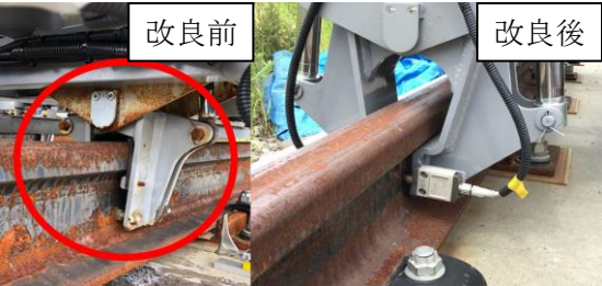
図-3 レールキャッチの形状変更
