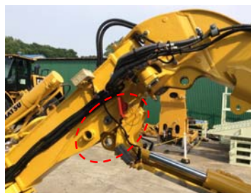
写真-6 高さ制限装置
