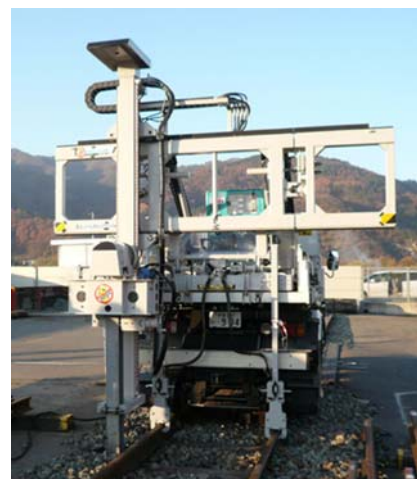
写真-2 軌陸ダンプ+専用振動機
