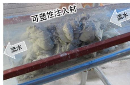
写真-2 流水分離抵抗性試験状況
