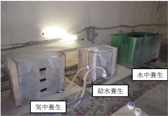
写真－1 供試体の養生状況
