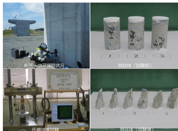
写真-2 小径コア試験状況
