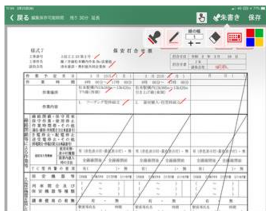
図-1 BIMクラウドを用いた保安打合せ
