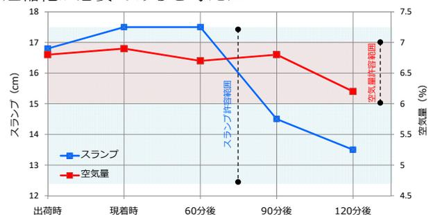
図-1 スランプと空気量の経時変化
