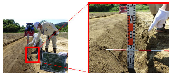
写真-2 石礫深さの確認状況 (CASE1 : 15cm)
