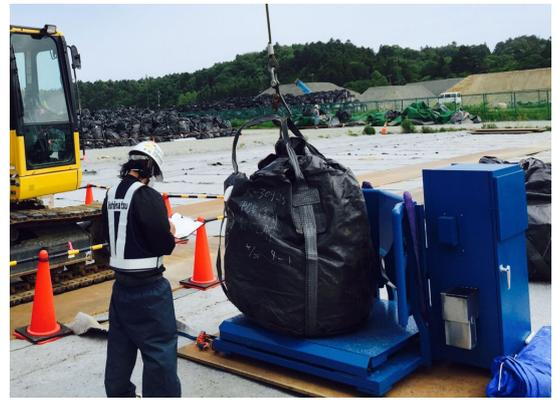
写真-3 CONVER によるフレコン重量と線量の測定状況
