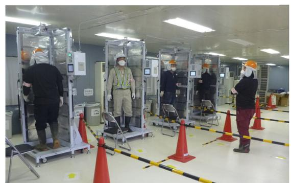
写真-2 体表面モニタによる汚染検査状況
