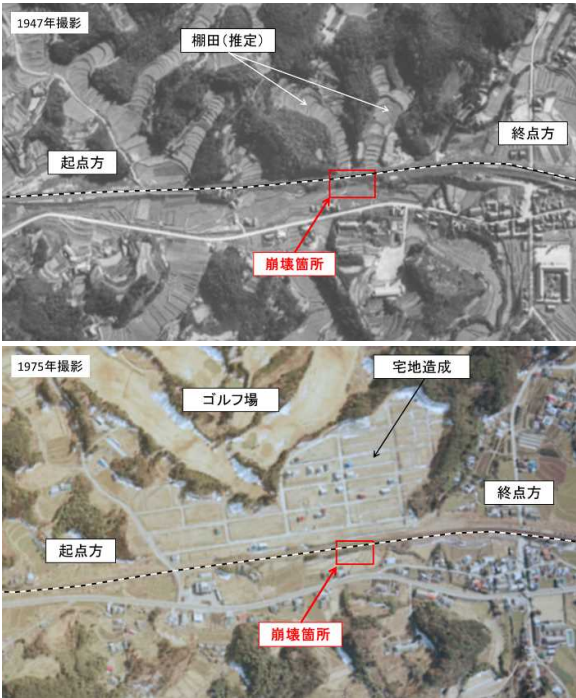
図 2 2 時期の空中写真の比較(被災した盛土周辺) (国土地理院撮影航空写真に線路周辺環境等を追記)
