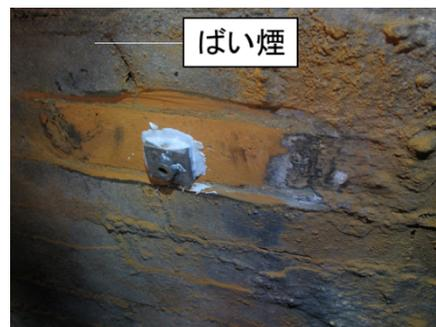
図1 建研式引張試験状況
