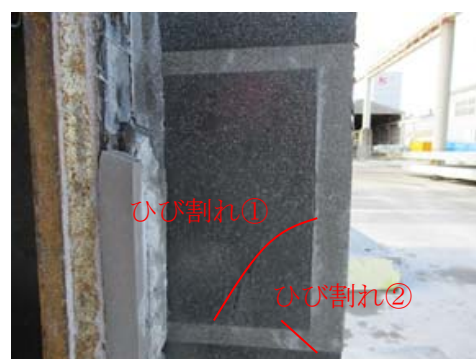
写真-2 試験後の PBL ブロック内部状態(ケース 1)
