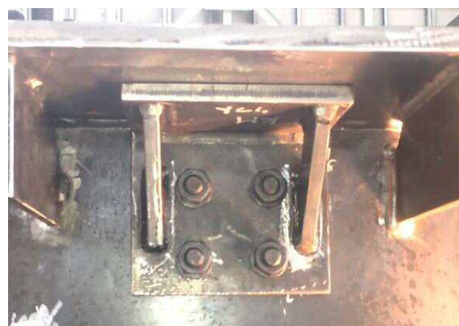
写真2 試験体への補強部材設置状況
