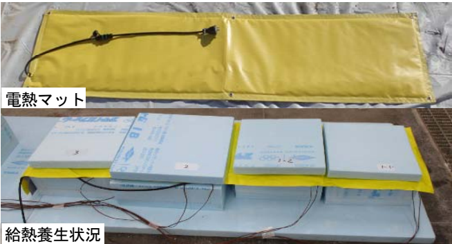
写真 1 電熱マットの外観および給熱養生状況
