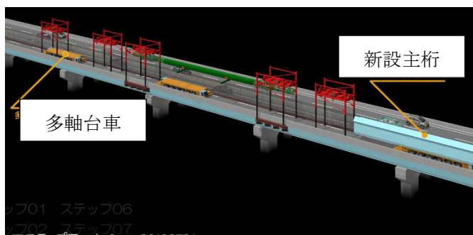
図-2(3) 既設桁搬出用多軸台車と新設桁の搬入
