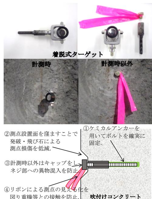
図-1 切羽直近への着脱式ターゲット設置状況
