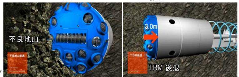
図-6 TBM の後退
