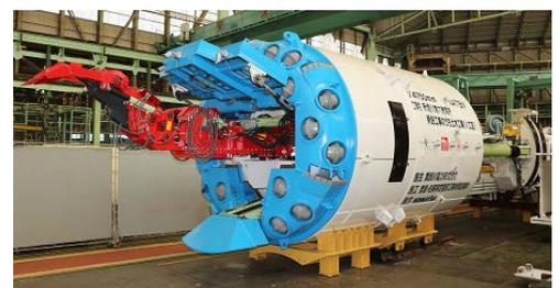
写真-1 NATBM 掘削機外観
