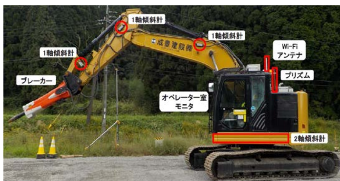
写真-1 重機機装状況
