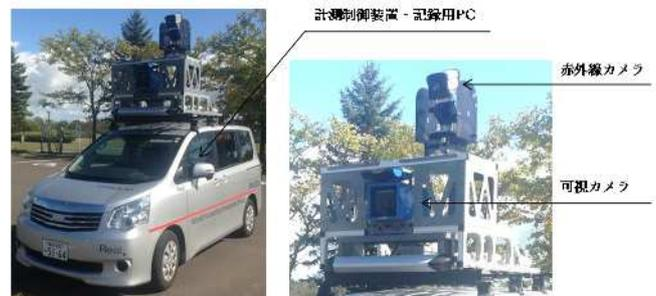
図-1 計測車両外観
