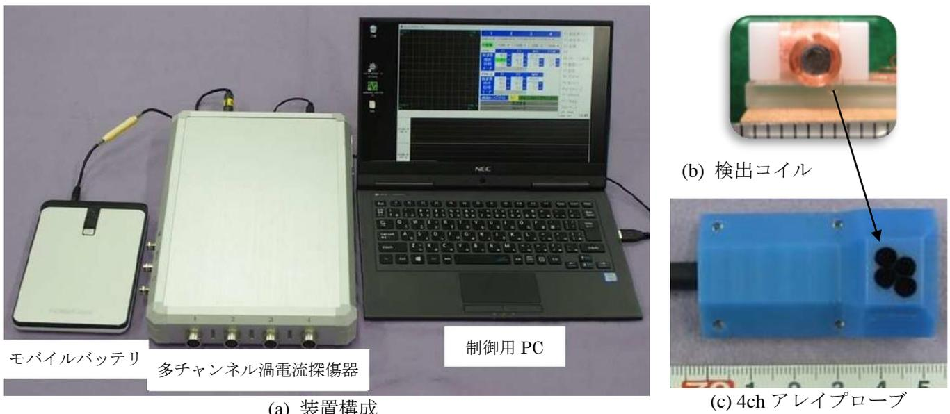
図 1 多チャンネル渦電流探傷システムの装置構成
