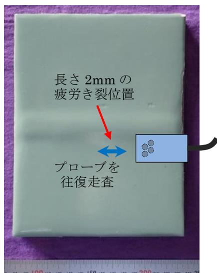
図 3 塗装後の供試体とプローブ走査位置
