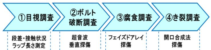
図3 鋼製フィンガージョイント検査の流れ
