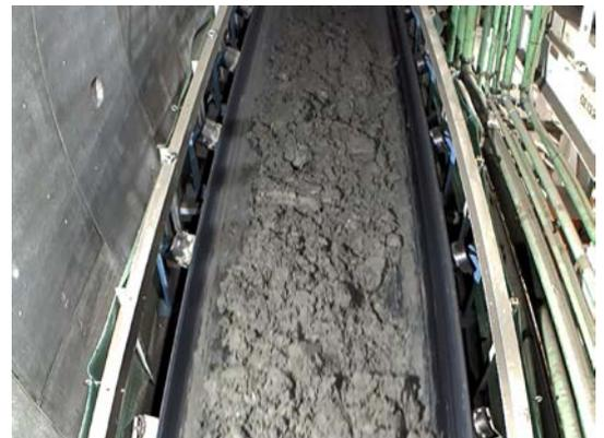
図-1 ベルトコンベヤーによる土砂搬出状況
