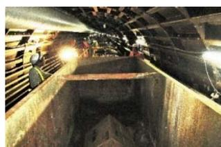
写真-4. 模擬土砂設置状況（底部）
