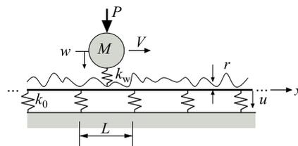
図1 走行車輪・軌道連成系モデル
