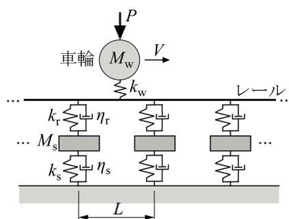
図2 車輪・軌道系のモデル化
