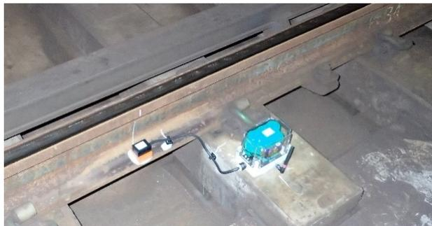
図-4 軌道内への加速度センサの設置状況
