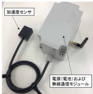
図-3 無線式加速度センサの例
