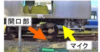
図 2 開口部走行試験の様子
