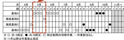
図 3. レール削正年間計画の例
