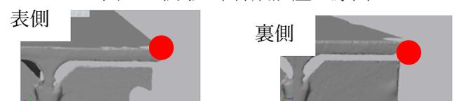
写真8. (方法4) 共通箇所に点を打ち、その点同士が重なるように位置を合わせる。(7箇所を設定)
