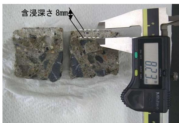
写真-3 含浸深さ試験結果
