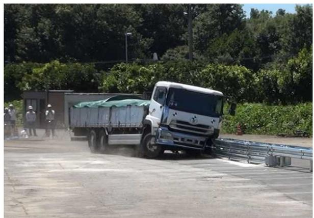
写真-2 大型車衝突試験による性能確認
