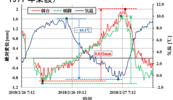
図-3 橋台および橋脚の絶対変位
