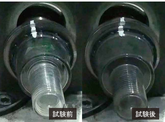
写真3: アンカーボルトM16 NAS振動試験 前後
