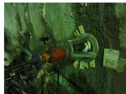
写真-2 引抜き試験の実施状況
