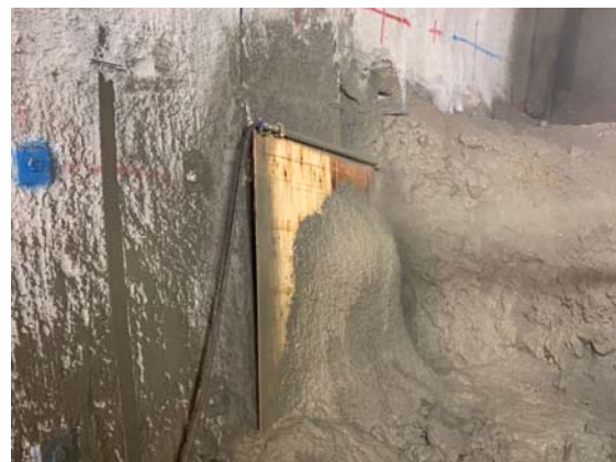
写真-2 模擬湧水下での付着状況(100L/min)
