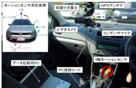
図-1 測定車両とセンサ(赤丸)設置状況
