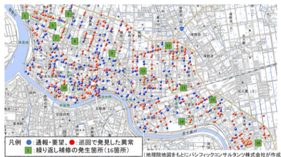
図-1 巡回時の重点監視ポイント【現場支援1】
