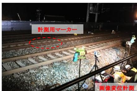
図-8 画像変位計測による鉛直変位計測状況
