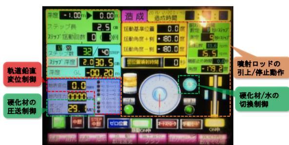
図-7 リアルタイム管理装置自動制御画面
