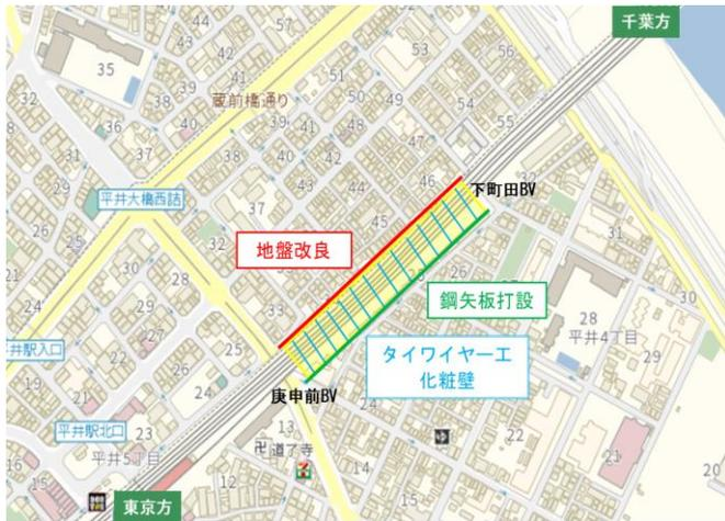
図-1 施工箇所図(©NTT 空間情報)
