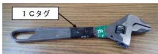
図-1 ICタグを取り付けたスパナ
