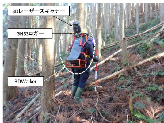
図1 3Dレーザーによる測定状況
