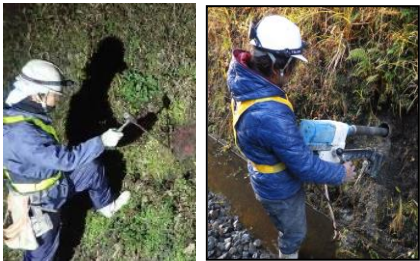
(a)鉄筋貫入試験 (b)簡易ボーリング 図 1 背面地山の調査方法
