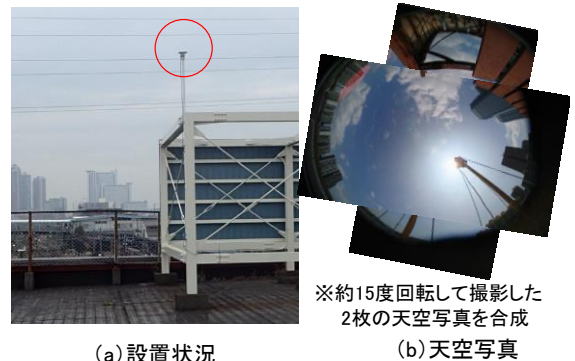
図 2 基準局のアンテナの設置状況
