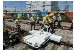
図2 分岐器検査装置
