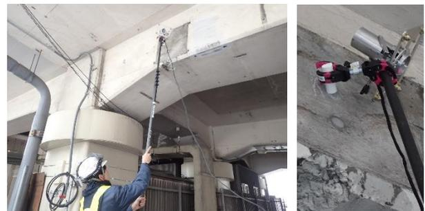
写真-2 打検機使用状況
